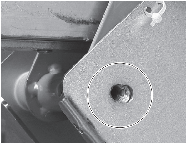
Pav. 5.9 Gylio reguliavimo varžto anga (kad geriau matytųsi varžtas išimtas)
