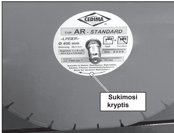
Pav. 3.15 Sukimosi krypties žymėjimas ant disko
