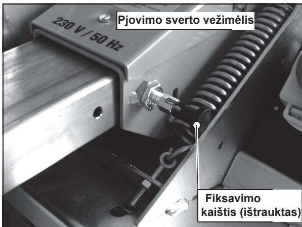
Pav. 3.5 Pjovimo svertas neužfiksuotas (fiksavimo kaištis ištrauktas)
