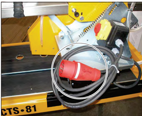
Pav. 3.7 400 V / 50 Hz stalnio pjaustytuvo kištukinis lizdas
