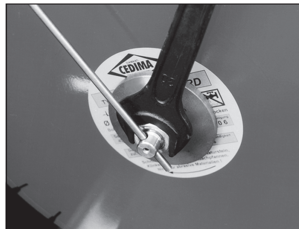
Pav. 3.18 Pjovimo veleno veržlės užveržimas veržliarakčiu, prilaikant veleną strypu
