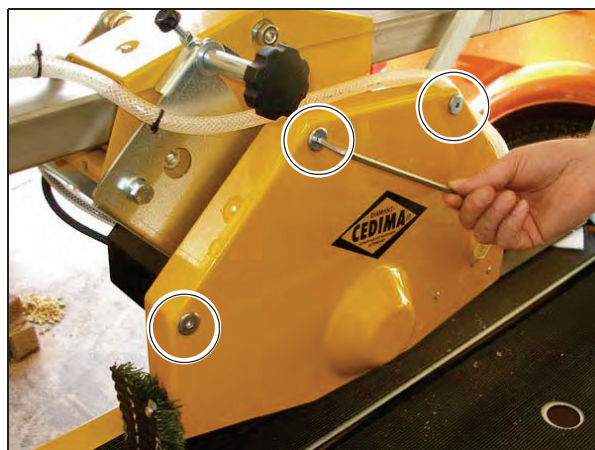
Pav. 3.13 , Disko apsauginio gaubto fiksavimo veržlės
