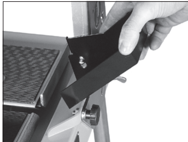
Pav. 3.2 Priekinės apsaugos užkabimas
