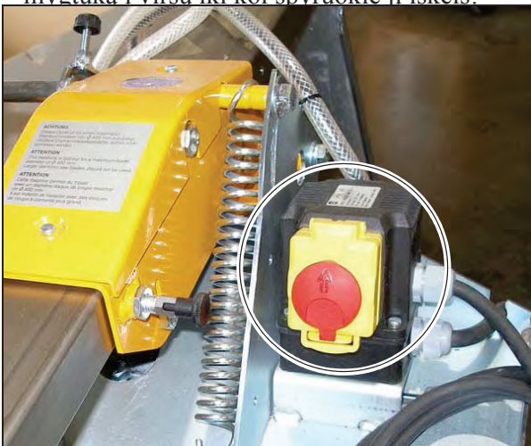
Pav. 3.9 Pagrindinis jungiklis su avarinio stabdymo mygtuku
